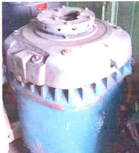
2- Motor de Eje Hueco de 250HP, Quemado en Almacén
